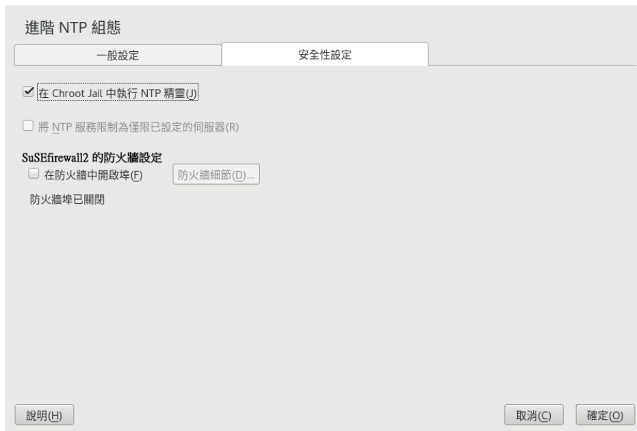
圖形 24.2 進階 NTP 組態：安全性設定
