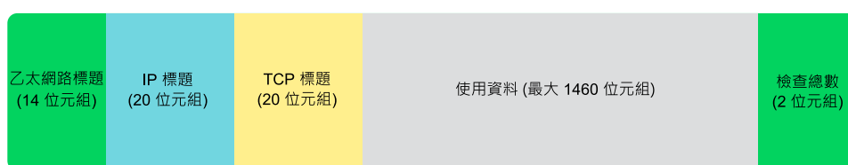
圖形 16.2 TCP/IP 乙太網路封包
